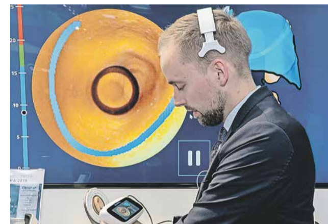
Macht unangenehme Abformungen des Ohres überflüssig: Otoscan erstellt ein genaues 3D-Modell des Gehörgangs.
